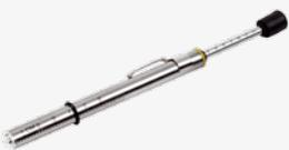
La medición de la tensión estática de una correa con el tensímetro TEXROPE® es una buena forma de evitar problemas en las transmisiones por correas, puesto que permite comprobar si la instalación es correcta y realizar revisiones periódicas de la tensión de la correa.
