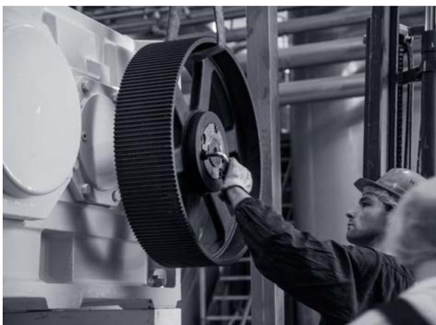
Compruebe que todas las poleas estén correctamente ensambladas y que los pernos o los tornillos estén ajustados al par adecuado. Causas de la desalineación de las poleas
