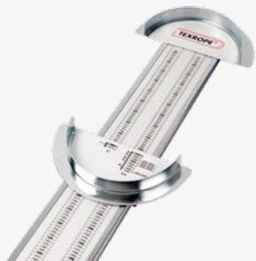
¿Cómo se miden las correas trapeciales clásicas y de sección estrecha? Utilice la herramienta de medición de correas TEXROPE®. Este sólido dispositivo metálico permite medir correas trapeciales con longitudes del paso comprendidas entre 540 y 2500 mm (el 60% de todas las correas industriales del mercado).
