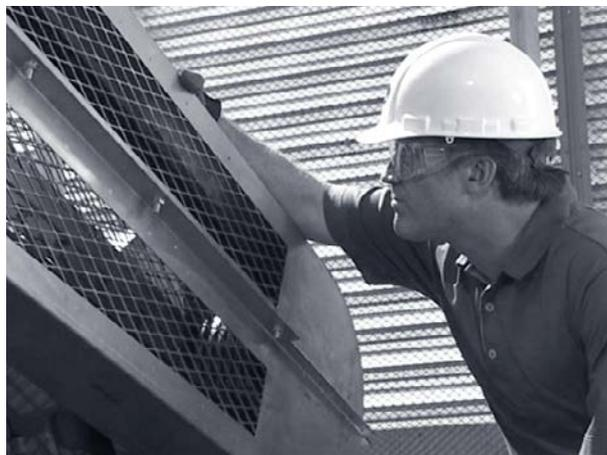
*Compruebe si existen ruidos o vibraciones anormales mientras observa el funcionamiento de la transmisión protegida.*
